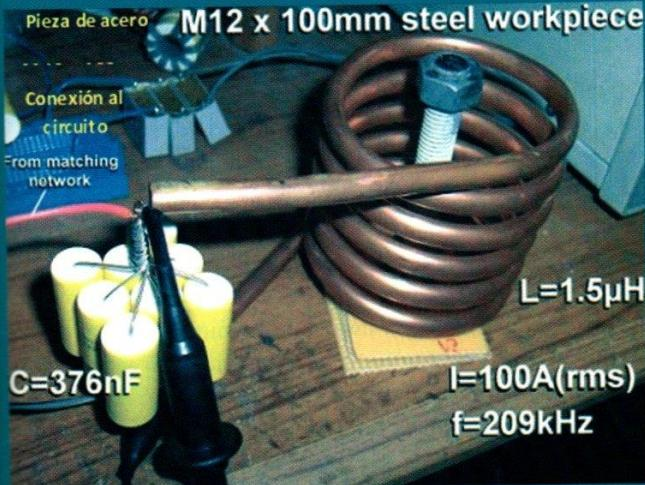
● Horno experimental de inducción. Por el caño de cobre circula una corriente alterna de 100 ampere, y de más de 200 kilociclos por segundo. El tornillo y la tuerca de hierro se magnetizan repetidamente hacia un lado y el opuesto, a la misma frecuencia, proceso en el que el hierro se calienta. Se alcanzan 770 grados centígrados; la temperatura de Curie de ese metal, y a la que pierde sus propiedades ferromagnéticas.
